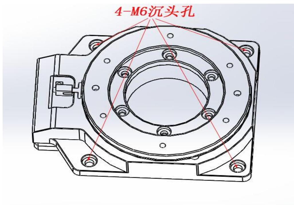
用4-M6内六角圆柱头螺丝将旋转平台固定在工作台上面上
