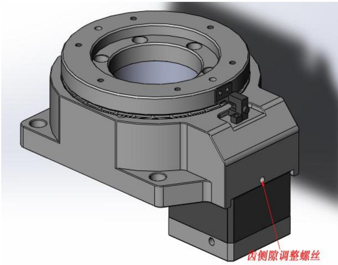
由于齿轮的磨损，当旋转平台长期使用后产生了齿轮侧向间隙，可通过上图齿侧隙调整螺丝预紧使间隙消除。
