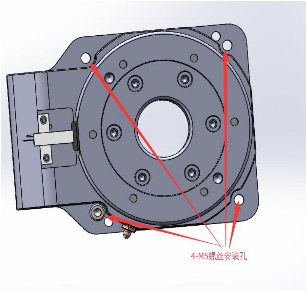
用4-M5内六角圆柱头螺丝将旋转平台固定在工作台面上
