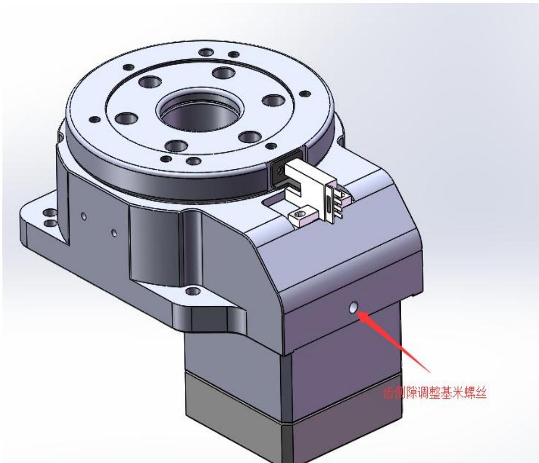
由于齿轮的磨损，当旋转平台长期使用后产生了齿轮侧向间隙，可通过上图齿侧隙调整螺丝预紧使间隙消除。
