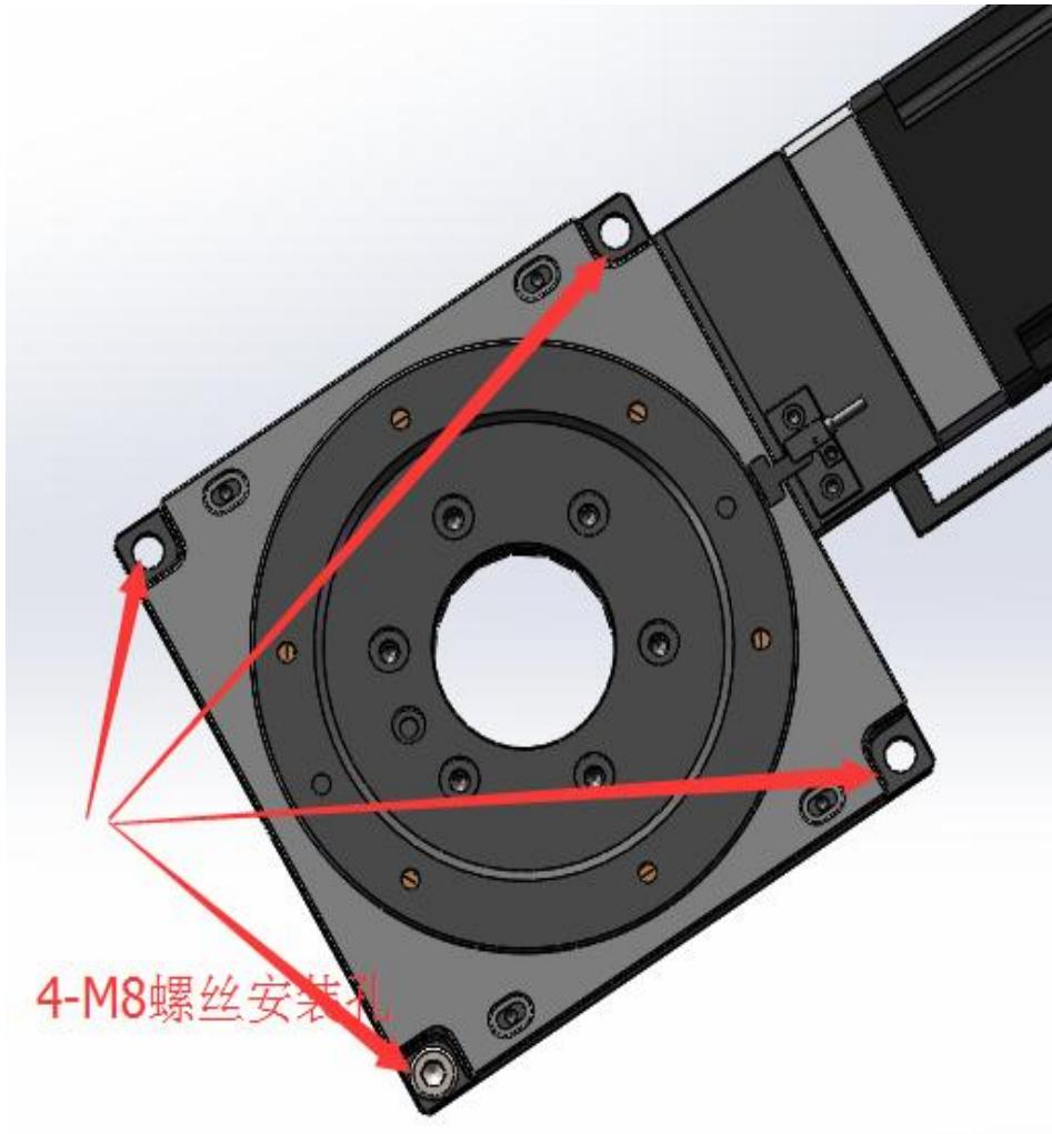
用4-M8内六角圆柱头螺丝将旋转平台固定在工作台上
