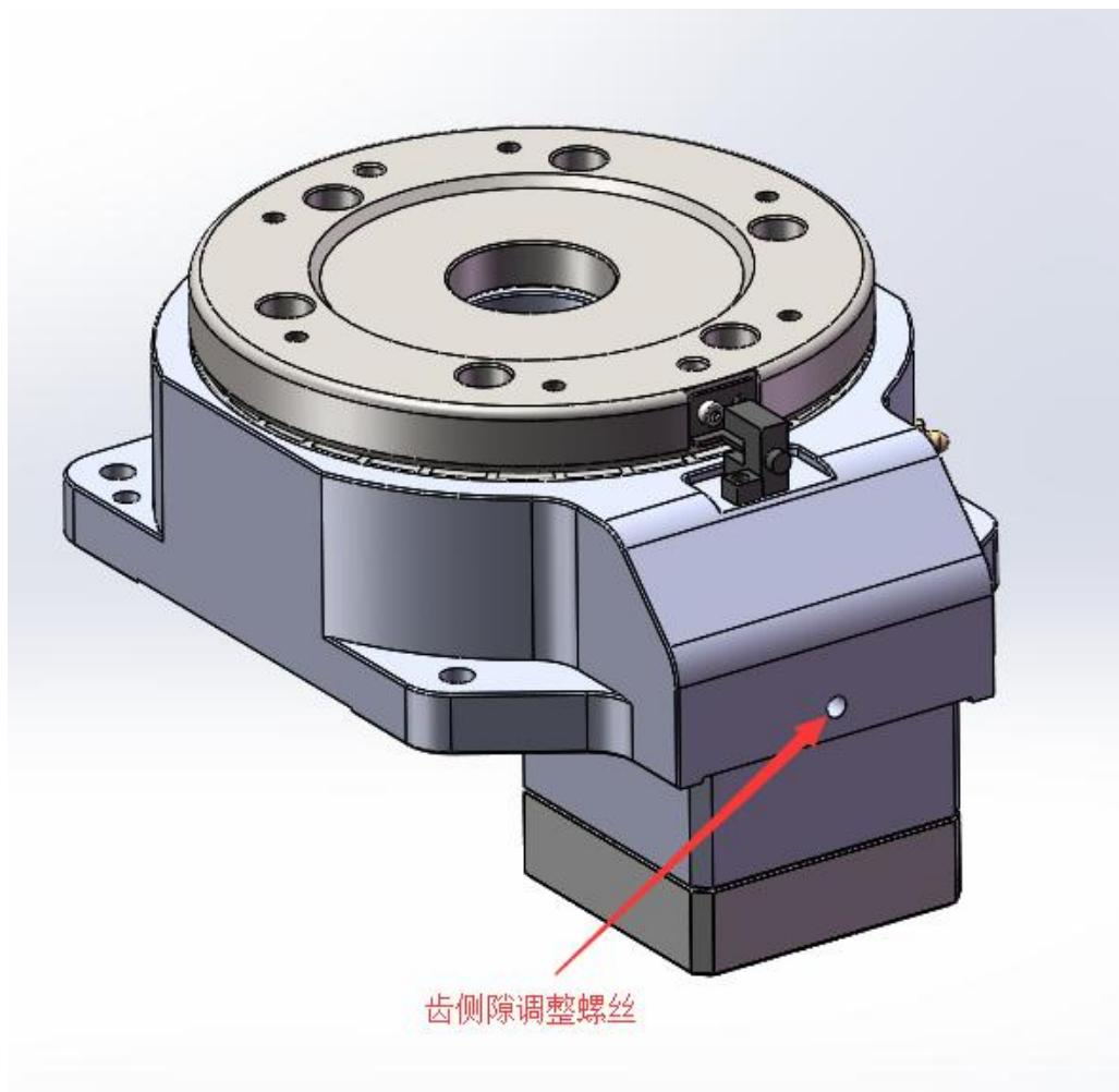
由于齿轮的磨损，当旋转平台长期使用后产生了齿轮侧向间隙，可通过上图齿侧隙调整螺丝预紧使间隙消除。
