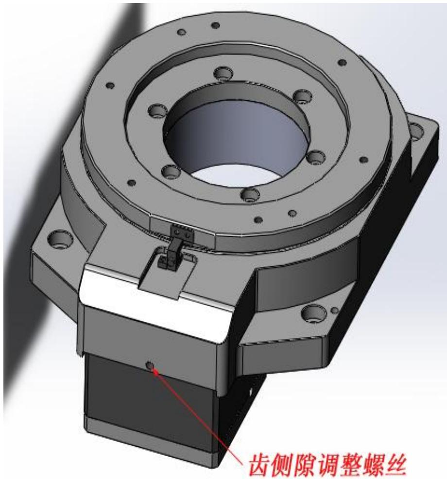
由于齿轮的磨损，当旋转平台长期使用后产生了齿轮侧向间隙，可通过上图齿侧隙调整螺丝预紧使间隙消除。
