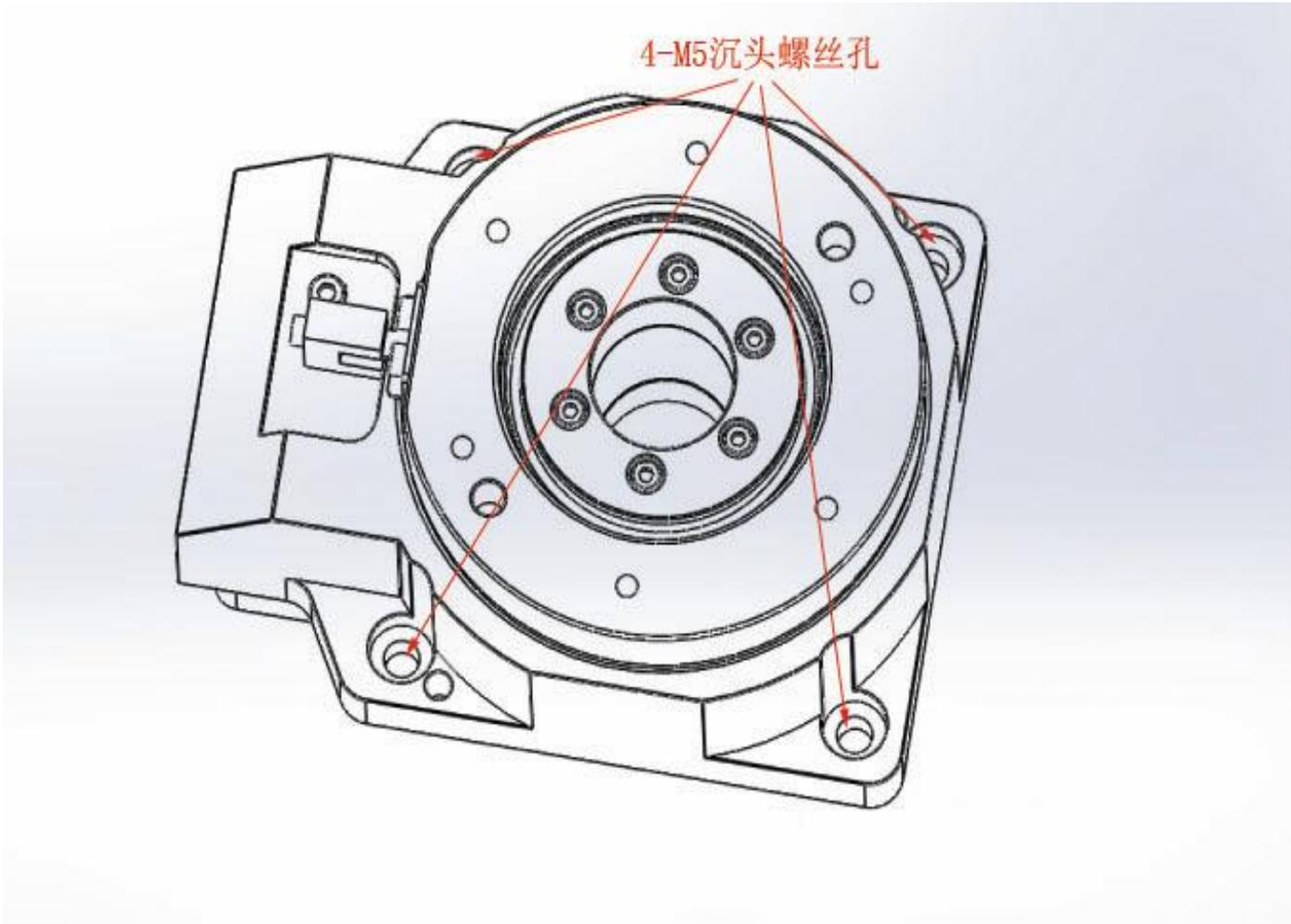
用4-M5内六角圆柱头螺丝将旋转平台固定在工作台面上
