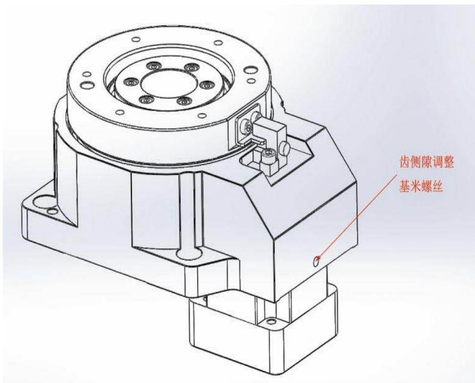
由于齿轮的磨损，当旋转平台长期使用后产生了齿轮侧向间隙，可通过上图齿侧隙调整螺丝预紧使间隙消除。
