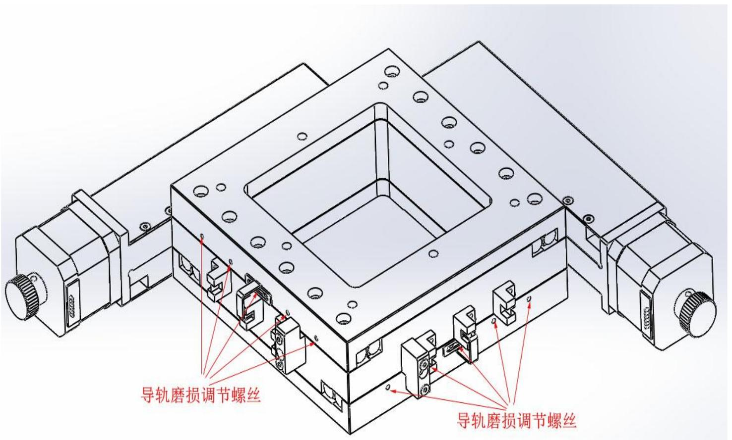
由于导轨的磨损, 当滑台长期使用后产生了侧向间隙, 可通过滑台侧边的交叉导轨间隙调整螺丝预紧使间隙消除(上图非实物仅供参考)。
