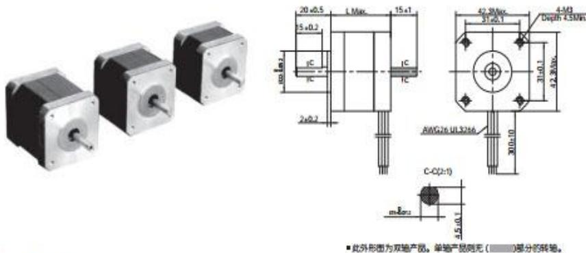
■ 此外形图为双轴产图, 单轴产图则无 ( ) 部分的转轴。
