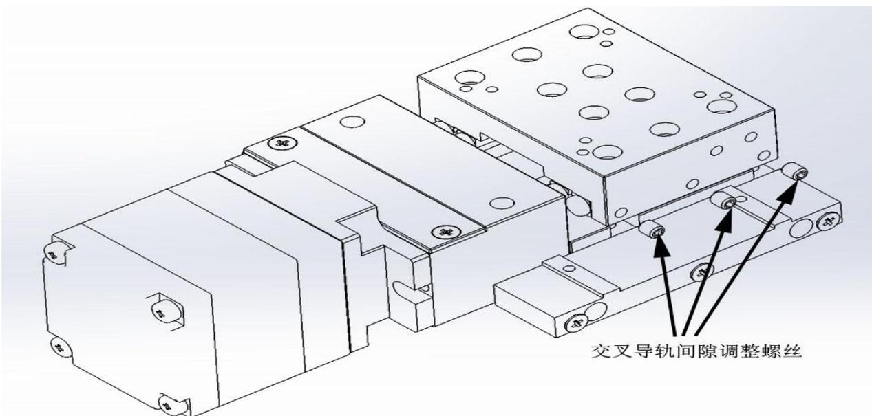
由于导轨的磨损，当滑台长期使用后产生了侧向间隙，可通过滑台侧边的交叉导轨间隙调整螺丝预紧使间隙消除。
