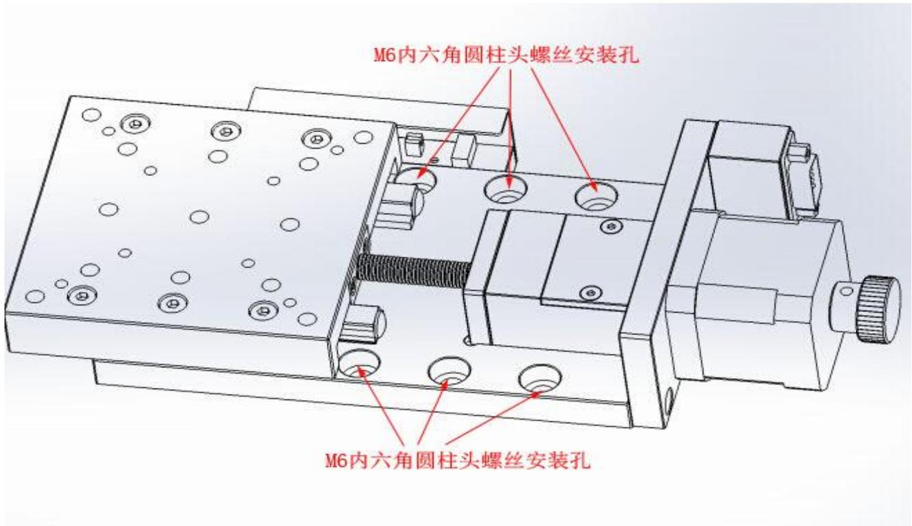
可以用螺丝将滑台固定在安装平面上
