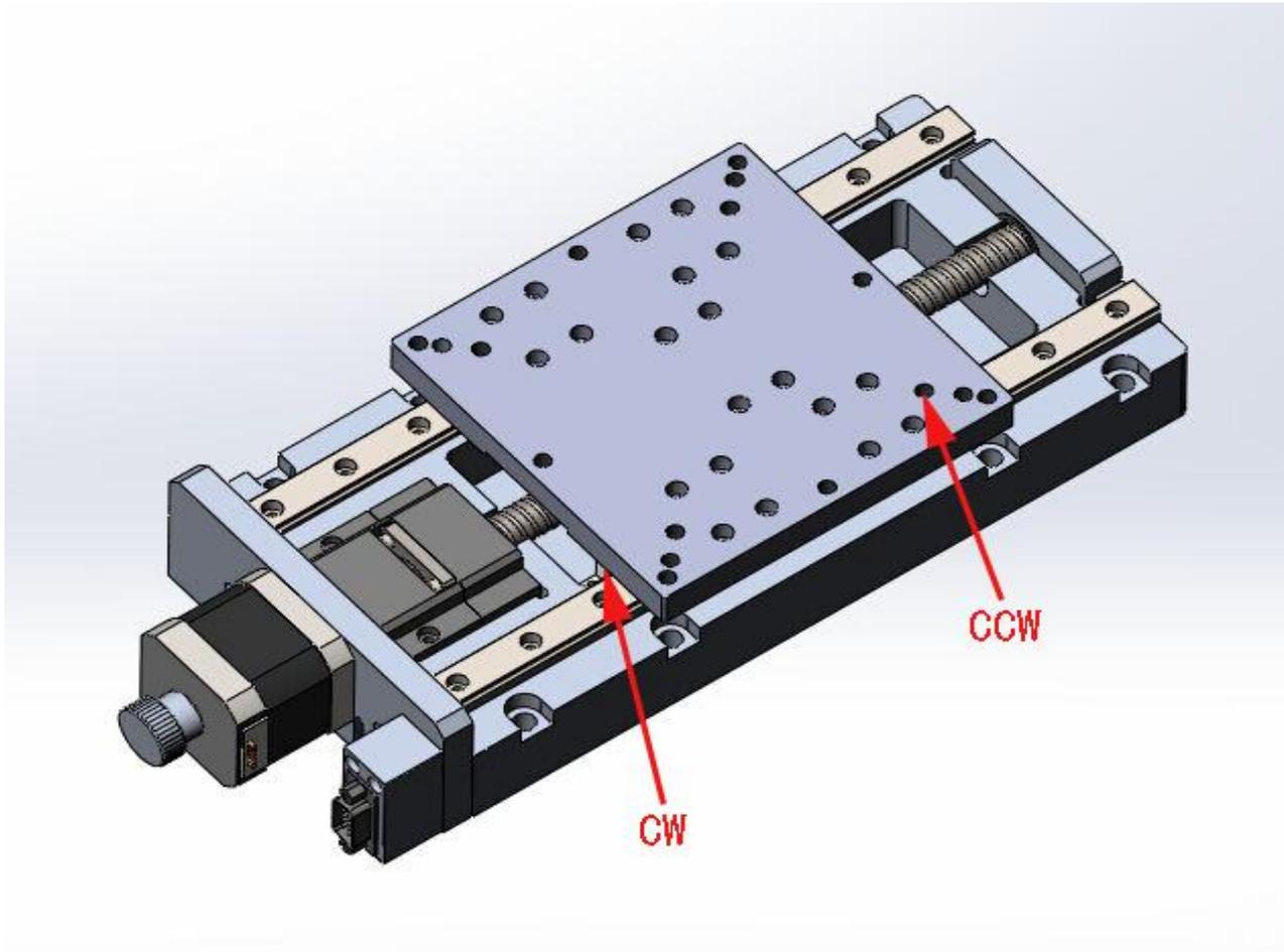
拧动电机尾部旋钮，将顶板驱动至CW或CCW侧，则可分别窥见安装螺栓孔（共6个）
