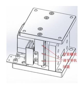
由于导轨的磨损,当滑台长期使用后产生了侧 向间隙,可通过滑台侧边的交叉导轨间隙调整 螺丝预紧使间隙消除。
