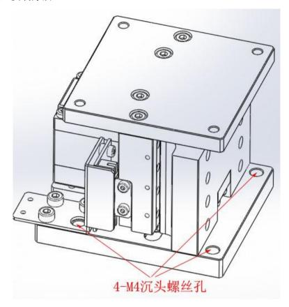
用4-M3的内六角圆柱头螺丝 将滑台固定于安装物上。
