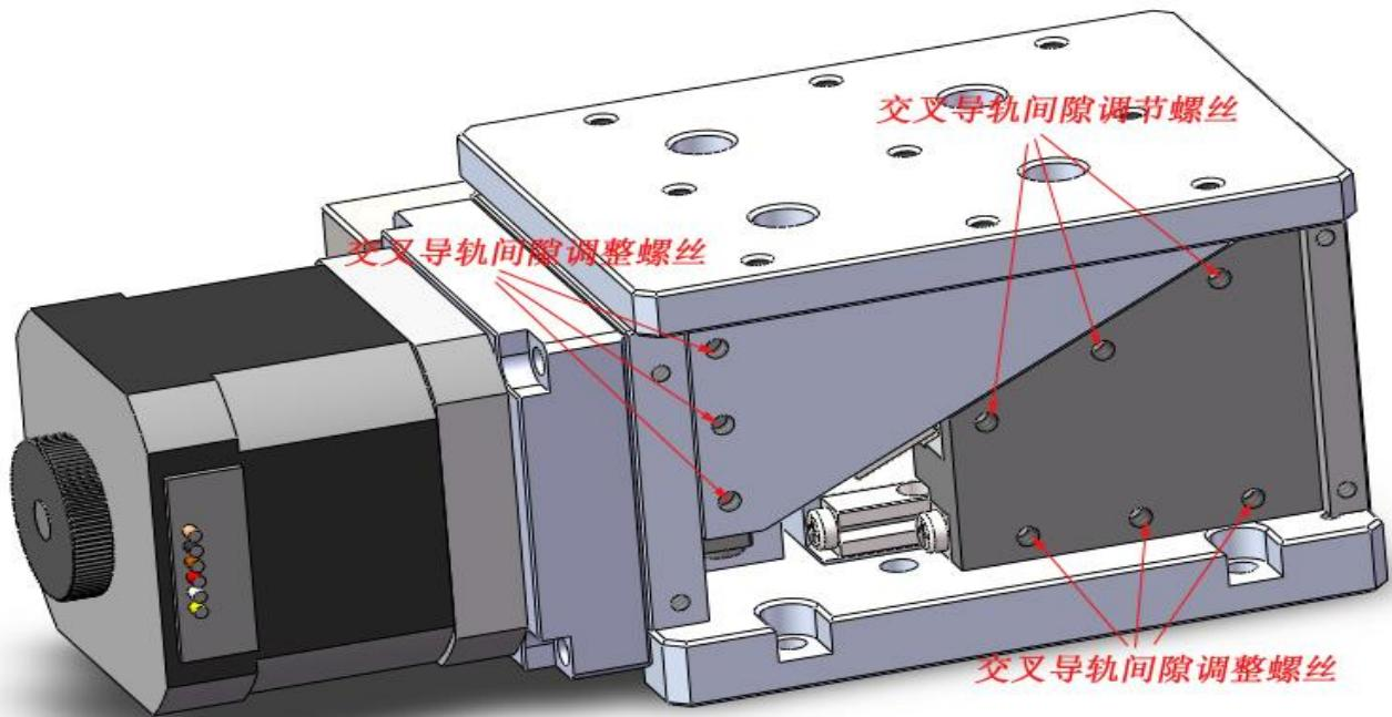
由于导轨的磨损，当滑台长期使用后产生了侧向间隙，可通过滑台侧边的交叉导轨间隙调整螺丝预紧使间隙消除。
