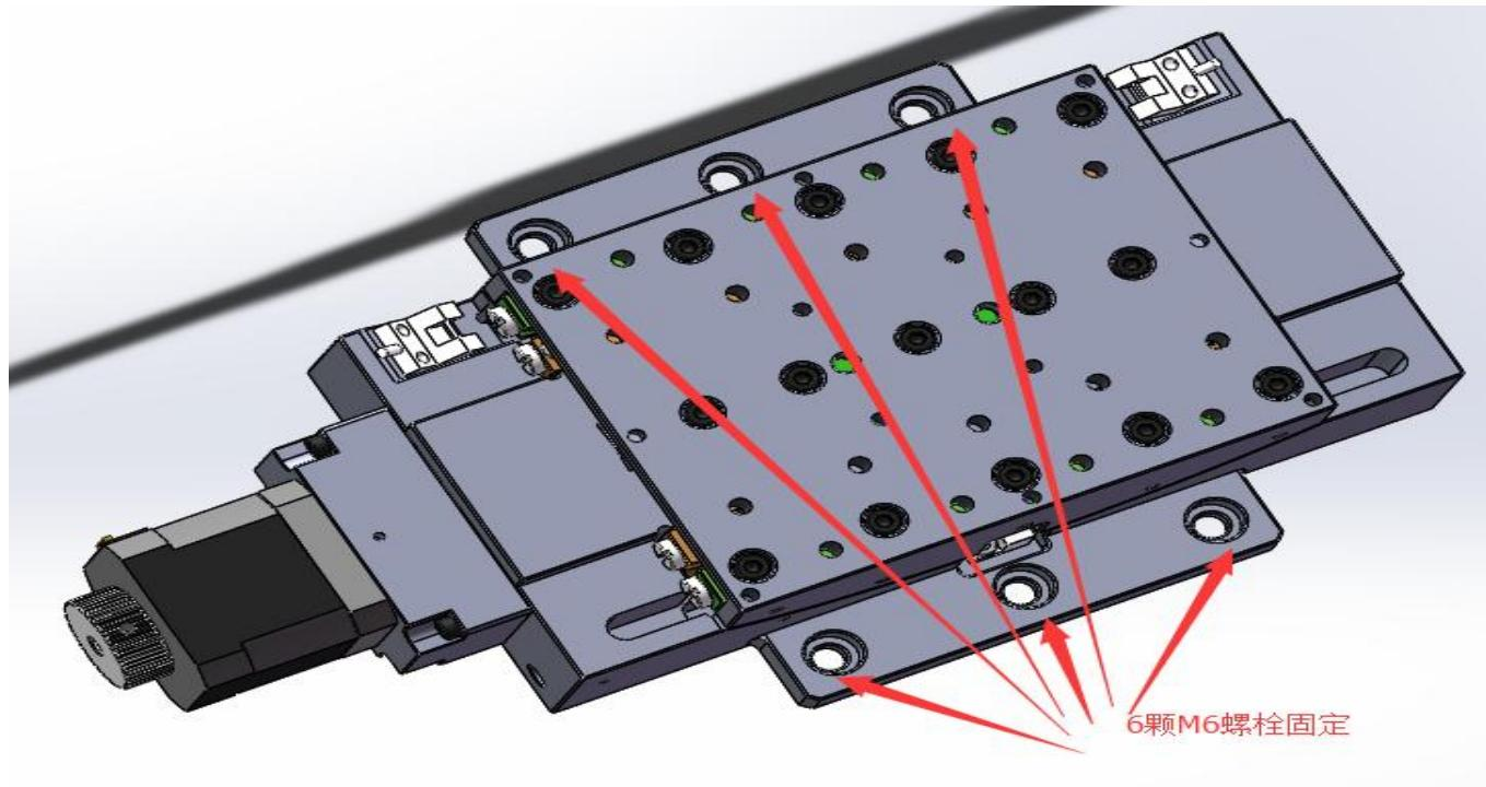
用6个M6圆头内六角螺丝将滑台固定在安装台上。
