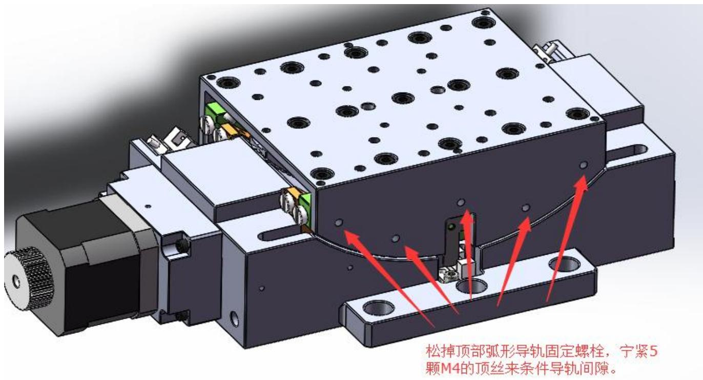
由于导轨的磨损，当滑台长期使用后产生了侧向间隙，可通过滑台侧边的交叉导轨间隙调整螺丝预紧使间隙消除。
