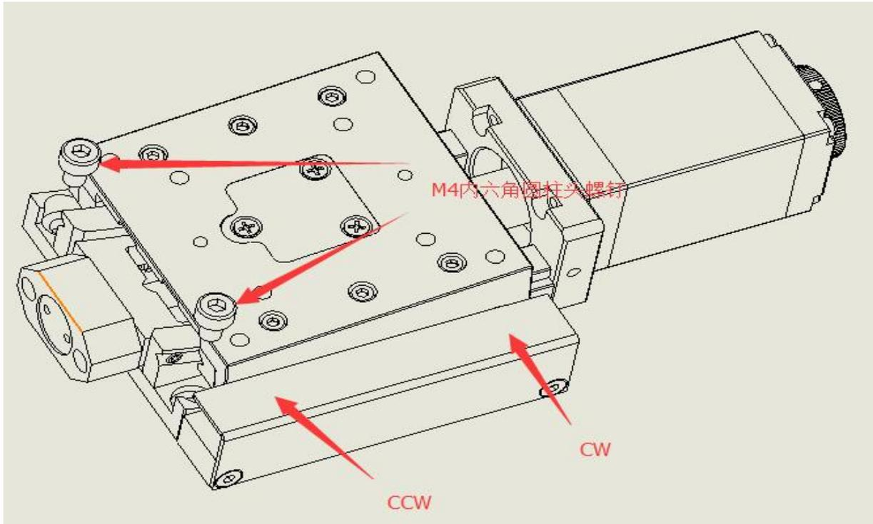
将顶板驱动至CW或CCW侧，则可窥见2个螺栓孔（共4个）。用4个M4圆头内六角螺丝将滑台固定在安装物上。
