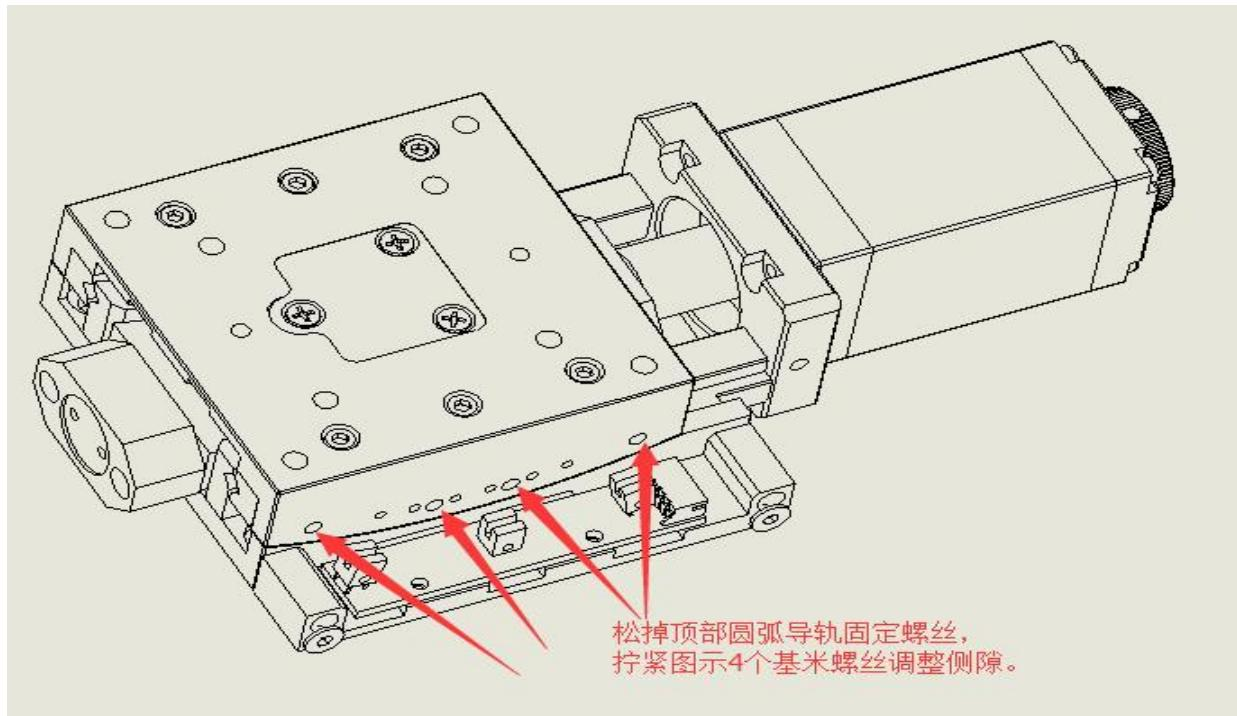
由于导轨的磨损，当滑台长期使用后产生了侧向间隙，可通过滑台侧边的交叉导轨间隙调整螺丝预紧使间隙消除。
