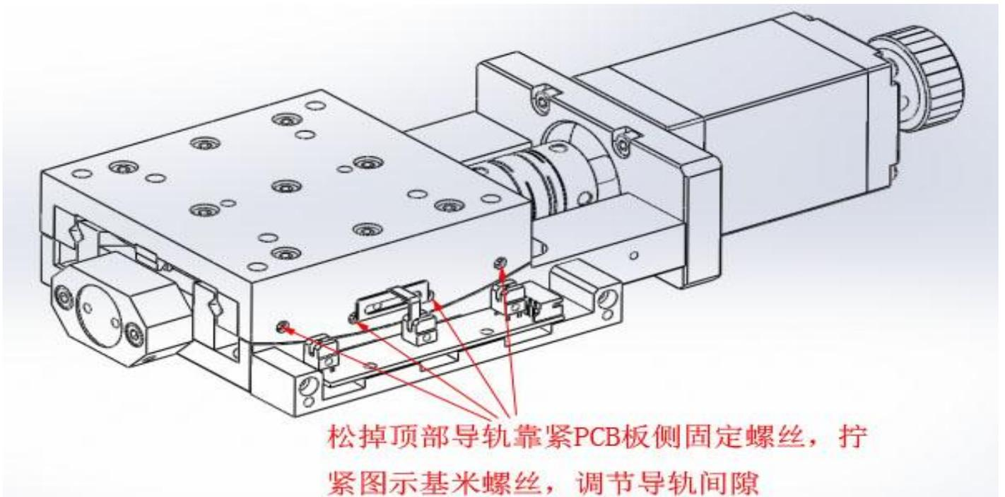
由于导轨的磨损，当滑台长期使用后产生了侧向间隙，可通过滑台侧边的交叉导轨间隙调整螺丝预紧使间隙消除。
