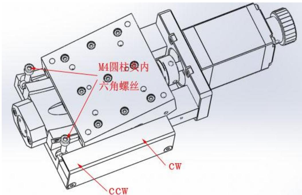
将顶板驱动至CW或CCW侧，则可窥见2个螺栓孔（共4个）。用4个M4圆头内六角螺丝将滑台固定在安装物上。
