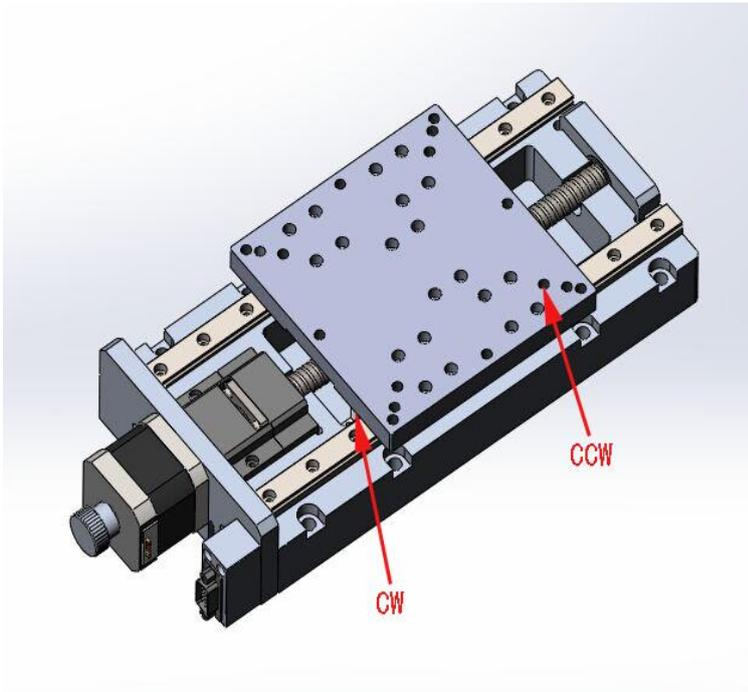
拧动电机尾部旋钮，将顶板驱动至CW或CCW侧，则可分别窥见安装螺栓孔（共6个）
